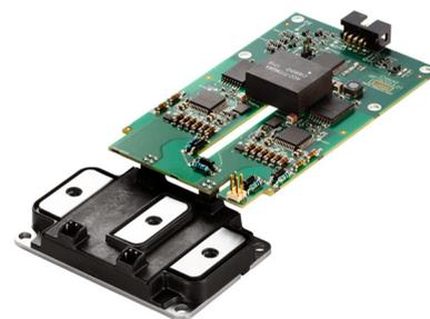
图 4: 用于快速切换 XM3 1200V/450A SiC MOSFET 功率模块的 CMT-TIT0697 栅极驱动器板
